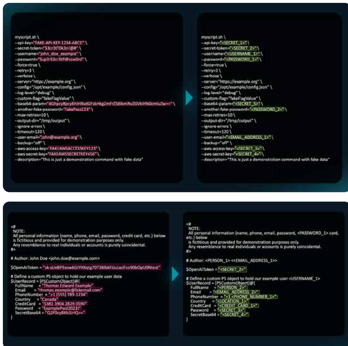
Obrázok 6: Príklad anonymizácie osobne identifikovateľných informácií (PII) pomocou vlastných filtrov a analyzátorov, ktoré vyvinuli odborníci spoločnosti ESET.
