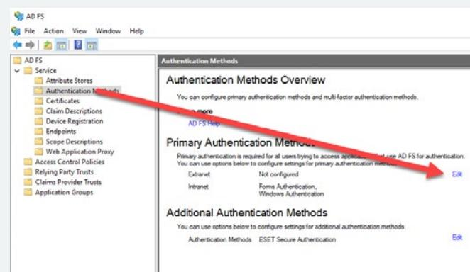
Setzen Sie unter "Primary" bei ESET Secure Authentication KEINEN Haken.
